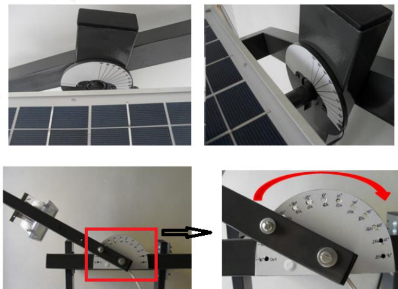
Figura 1. Protótipo desenvolvido na UnB para verificar a influência da posição da radiação solar e com a latitude sob a geração de energia elétrica.
